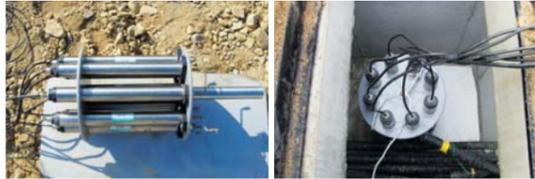
그림9. 층별침하게 자동측정 센서
