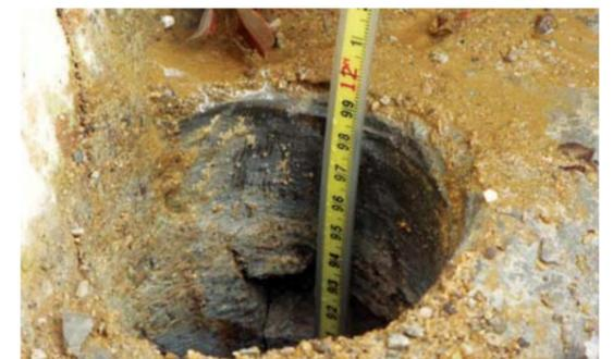
그림 7. 심도측정 및 간극수압계 설치\_1
