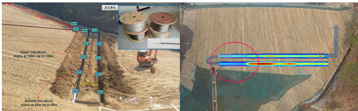
〈그림 5〉 (좌) 온도센서 매설 전경 (우) 온도 센싱을 통한 누수영역 탐지
